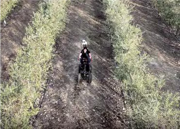
**Figura 2.** Escaneo LiDAR de una plantación intensiva de olivos para la caracterización en continuo del dosel foliar.
