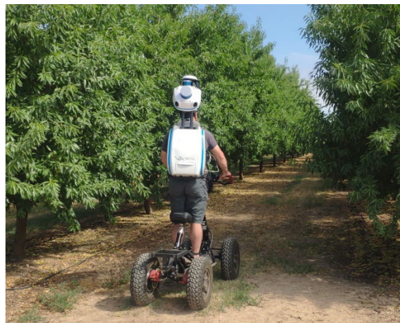
Figura 1. Escàner terrestre mòbil Viametris bMS3D del GRAP.
