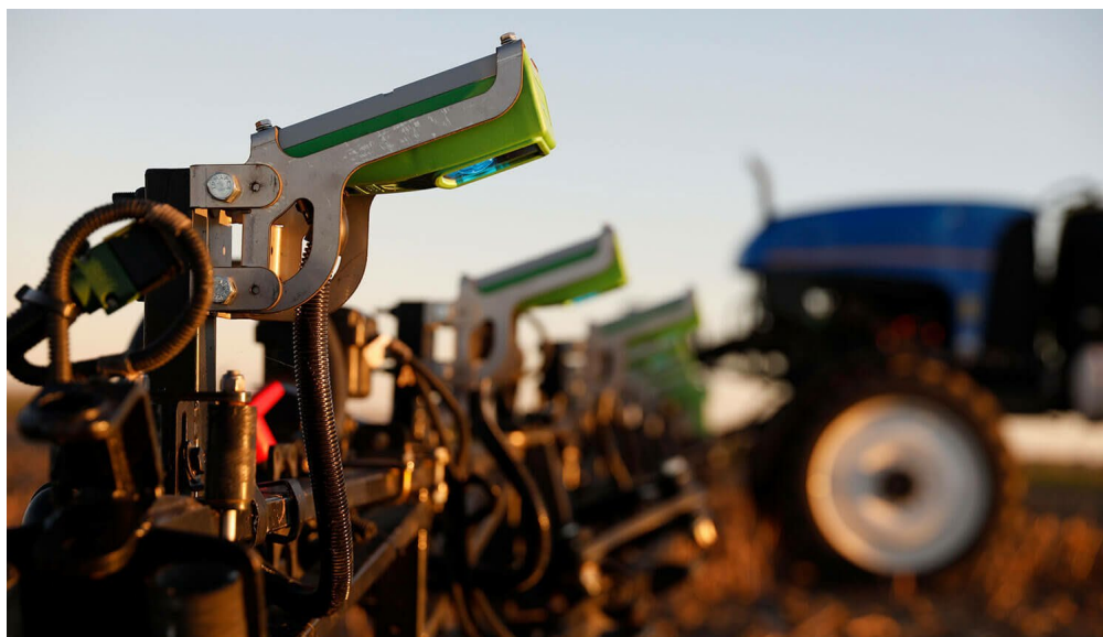
Figura 1. Sensor WEED-IT Quadro muntat en un polvoritzador automotriu.
