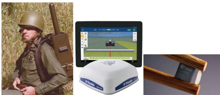
Figura 3. Esquerra: imatge de catàleg del primer receptor GPS comercial (revista GPS World). Centre: receptor GNSS per a Agricultura de Precisió i pantalla de visualització (Trimble). Dreta: receptor miniaturitzat per a incorporar en dispositius o elements diversos (U-blox).
